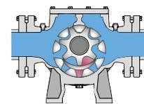
In den abgeschlossenen Kammern wird die Flüssigkeit zur Druckseite geführt. Dabei dient die Läuferbahn als Dichtungselement zwischen Saug- und Druckseite.
