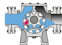
Wenn sich die Verzahnung von Rotor und Ritzel öffnet, bildet sich ein Vakuum. Dadurch wird das Fördermedium in die Pumpe gesaugt.
