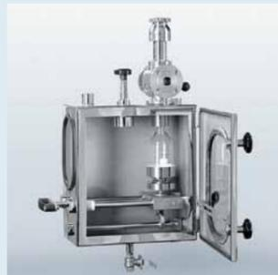
■ Probenahme von Flüssigkeiten; Schutzhschrank mit von außen verschließbarer Probeflasche
