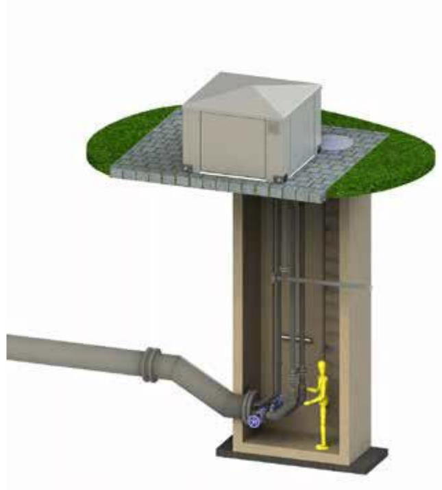
Der Trockenschacht ermöglicht den Zugang zu den Rohrleitungen.
