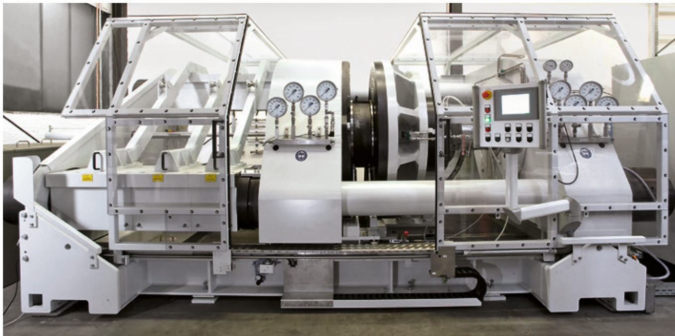
■ RITAG DN 1400/56" Prüfstand RITAG DN 1400/56" Test Facility
