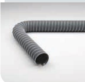
Absaug- und Gebläseschlauch für aggressive Medien bis +250°C, elektrisch leitfähig, Oberflächenwiderstand <math>< 10^6 \text{ Ohm}</math>
