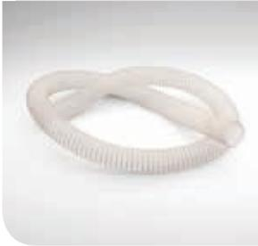
PU Absaug-/Förderschlauch, sehr leicht, Oberflächenwiderstand <math> < 10^9 \text{ Ohm}</math>, permanent antistatisch, mikrobenresistent, schwer entflammbar
