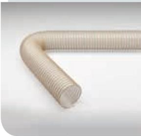
PU Absaug- und Förderschlauch, mittelschwer, gute Flexibilität, mikroben-/hydrolyse-resistent, permanent antistatisch, Oberflächenwiderstand  $< 10^9$  Ohm
