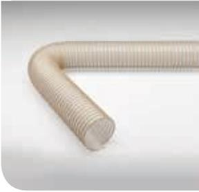
PU Absaug-/Förderschlauch, flexibel, Oberflächenwiderstand  $< 10^9$  Ohm, permanent antistatisch, mikrobenresistent, schwer entflammbar
