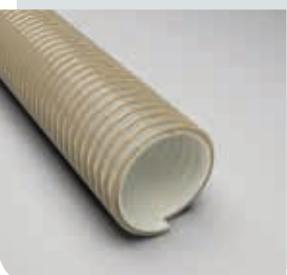
PU Absaug-/Förderschlauch, extrem abrieb-/vakuumfest, innen nahtlos glatt, antistatisch,  $< 10^9$  Ohm, mikrobenresistent
