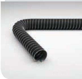
Absaug- und Gebläseschlauch für aggressive Medien bis +175 °C, elektrisch leitfähig, Oberflächenwiderstand  $< 10^6$  Ohm
