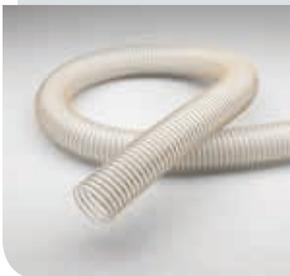
PU Absaug-/Förderschlauch, sehr flexibel, Oberflächenwiderstand <math> < 10^9 </math> Ohm, permanent antistatisch, mikrobenresistent, schwer entflammbar
